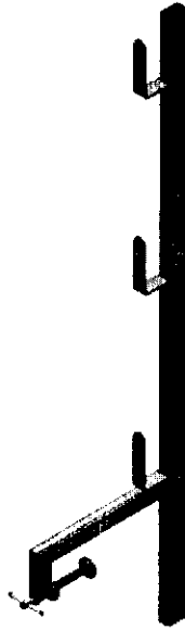
Fig. 9.1.2.1.1-1 Parapetto provvisorio ammorsato con ganascia fissa
